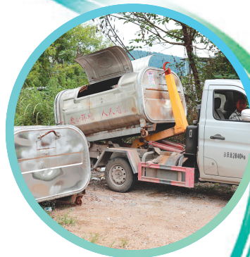
↑垃圾运输车定期清运村内勾臂垃圾箱垃圾。
