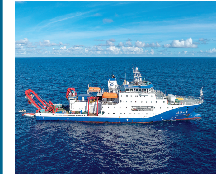
▲9月30日，“蛟龙”号进行第464次下潜作业，深度达7035.3米。这是“深海一号”船在布放“蛟龙”号入海（无人机照片）。
