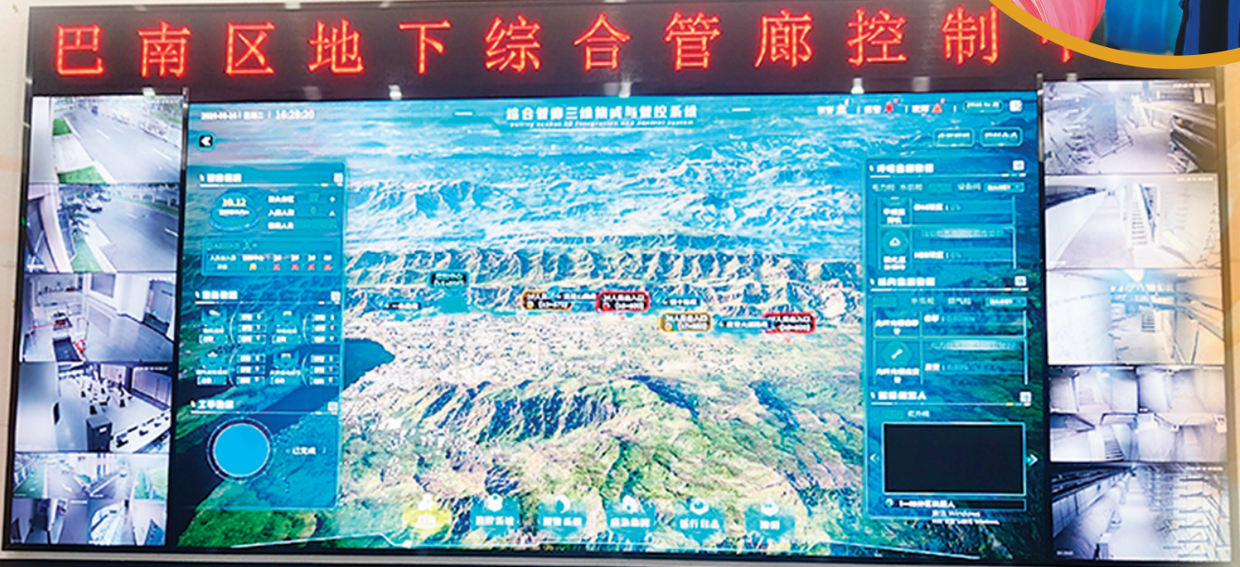
▲ 2026 年 6 月 16 日，在重庆市巴南区地下综合管廊控制中心，工作人员通过综合管廊三维集成与管控系统查看巴南区龙洲湾片区地下综合管廊的环境、结构等监测数据。 新华社记者 郑世昌 摄
