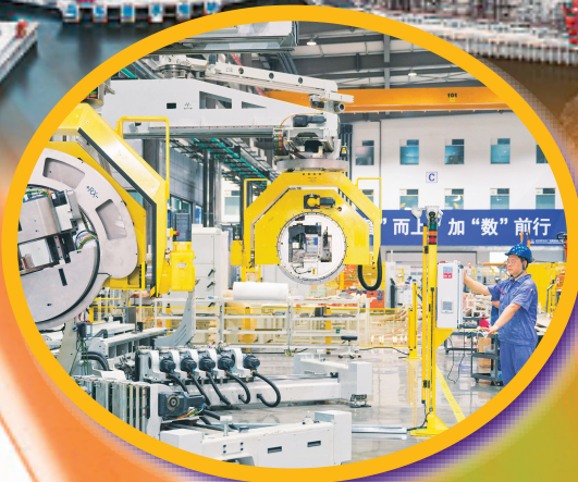
▲2026年7月28日，在哈电集团哈尔滨电机厂有限责任公司线圈数字化车间，工人操作智能制造设备为定子线棒弯型。新华社记者张涛 摄
