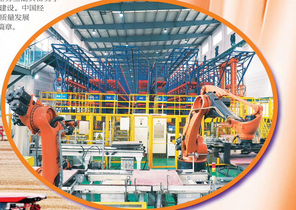
▲在江铜集团贵溪冶炼厂智能化电解车间，机器臂进行铜板转运作业（2026年1月21日摄）。 新华社记者万象 摄
