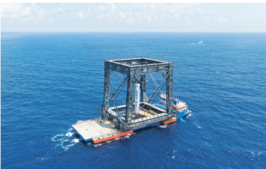
▲这是海上回收平台通过网系捕获方式成功回收长征十号乙运载火箭一子级(无人机照片)。
