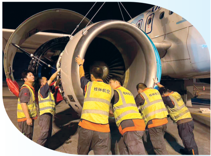
▲桂林航空维修团队进行飞机发动机进气道更换作业
