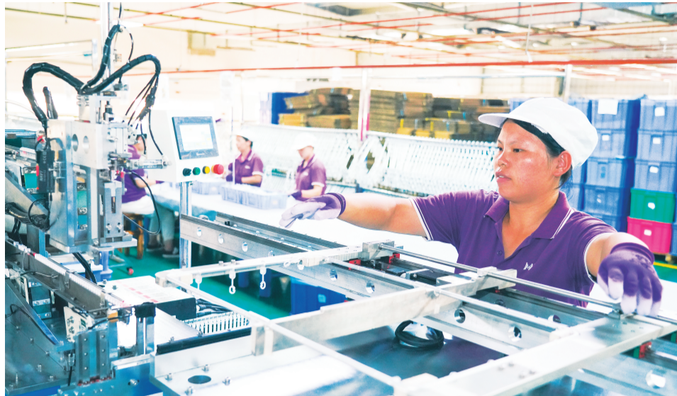
▲公司自主研发的多功能晾晒架塑料U型扣自动锁紧设备，使生产效率和产品合格率大幅提高。（桂林毛嘉工艺品有限公司供图）
