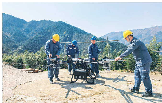
▲近日,南方电网广西桂林供电局在220千伏三上牵引线成功利用地线断股修补机器人完成受损地线修复工作。图为工作人员正在调试无人机。莫希涛 摄
