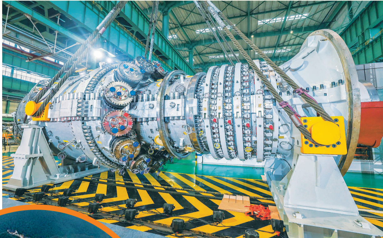
▲这是300兆瓦级F级重型燃气轮机（资料照片）。 新华社发
