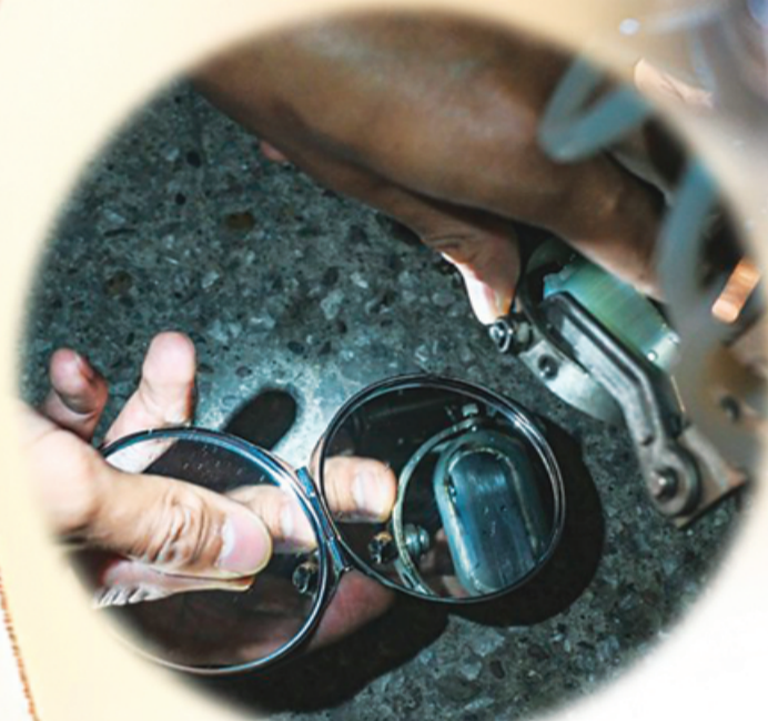
▲探伤工通过镜子检查探伤仪底部探头。
