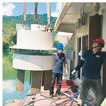
▲工人正在吊装直驱推进器。 五洲公司供图
