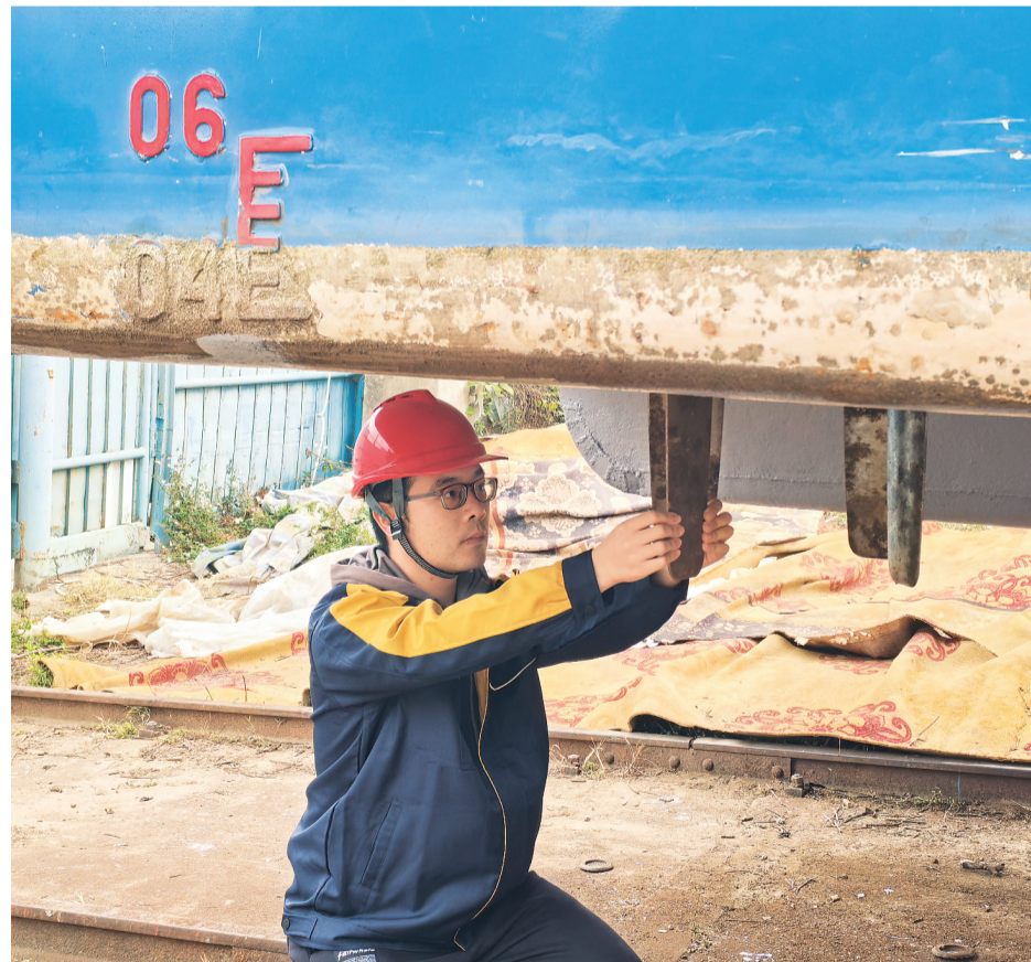
▲石智旭正在检查直翼桨叶间隙。
