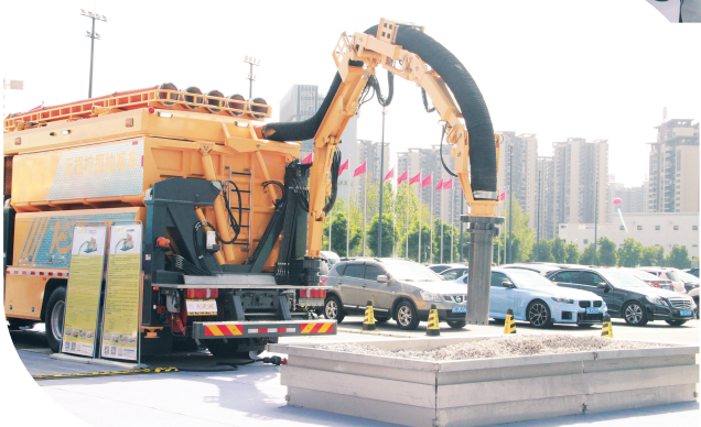
▲福建侨龙应急装备股份有限公司带来的系列助力强化城市自然灾害防治能力的新装备成为观众关注焦点。图为“龙来吸”无损挖掘抽吸车正在演示如何工作。
