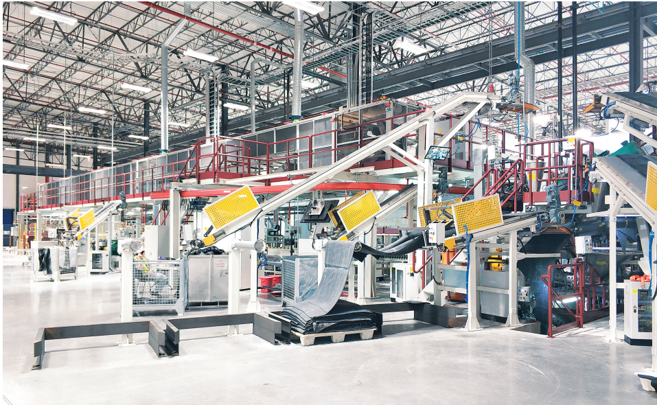
▲五复合橡胶挤出机组是高端绿色轮胎最先进最关键的生产工艺装备，主要用于多种橡胶的加工、复合、定型。（桂林橡胶设计院有限公司供图）
