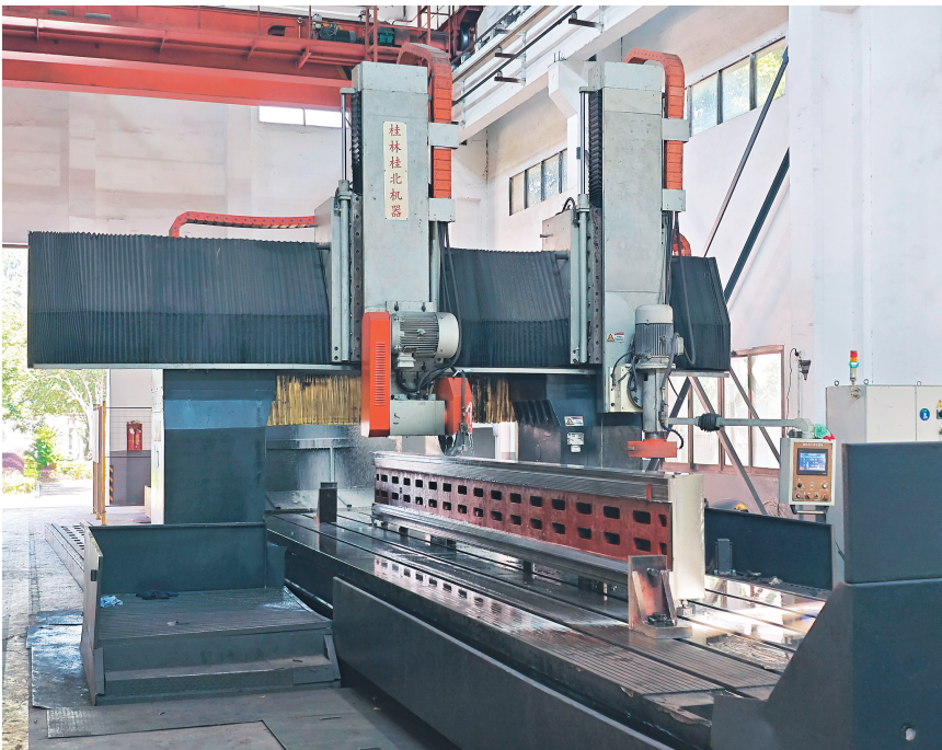
▲在桂北机器生产车间，大型数控龙门导轨磨床在工人操作下，正有条不紊地进行磨削加工。
