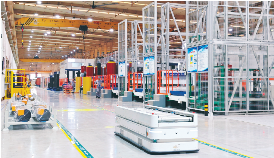
▲在君泰福高端干式变压器数字化工厂内,只需在手机端一键下达任务,AGV 背负式搬运机器人便会根据预设的路线自动行驶,将物料准确送达指定工位。
