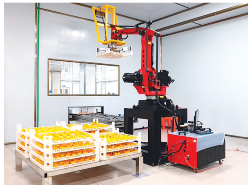
▲在广西柿界食品科技有限公司,机器人将码堆柿子送入内包装车间。
