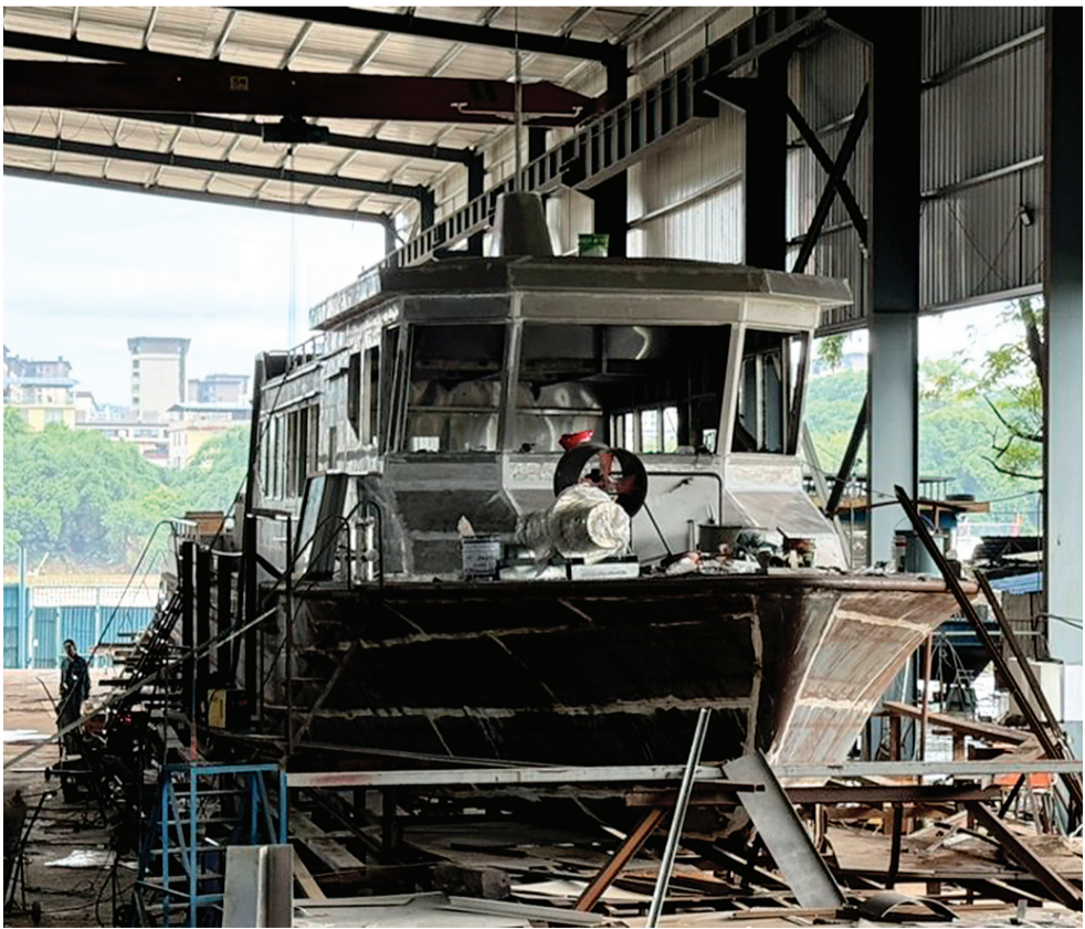
▲在造船车间，一艘新能源船舶已然成型。该船将搭载直翼舵桨推进器和电力推进系统。
