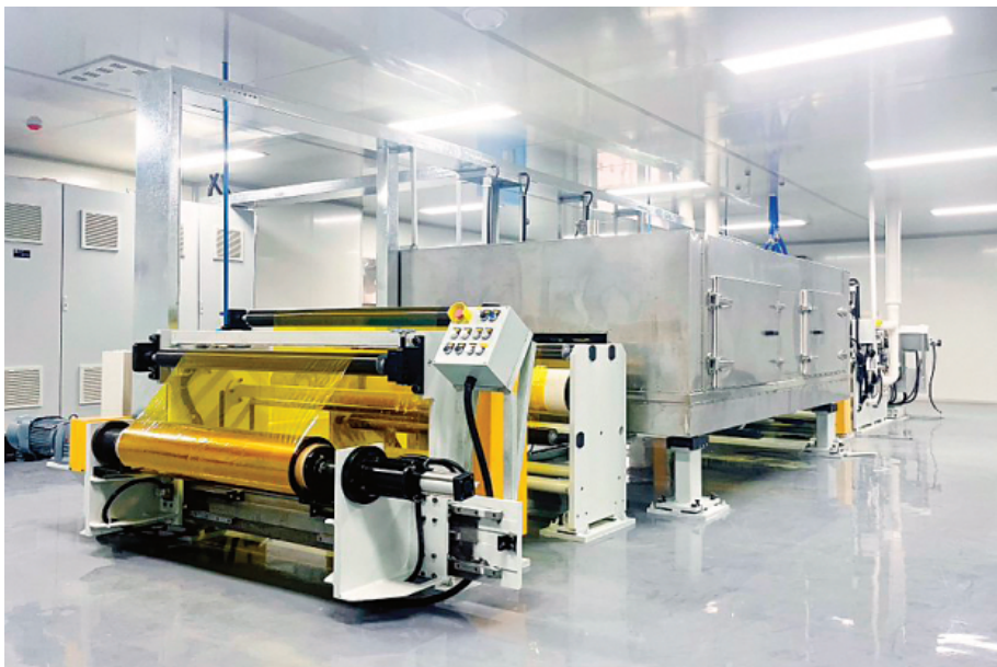
▲国内首条 1.6 米幅宽 BOPI 薄膜生产线，被认定为国内首台（套）重大技术装备产品，解决了我国航空、航天等应用领域对宽幅 PI 薄膜的需求。（桂林电科院供图）
