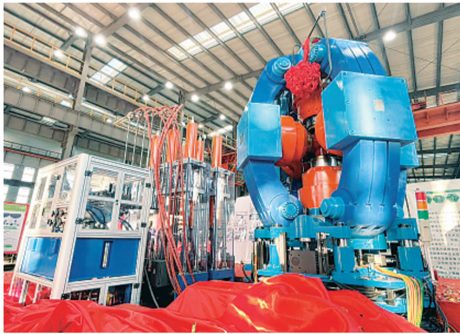
▲中国首台真三轴六面顶液压机在桂林诞生，是我国首台能同时产生超高压、超高温、偏应力的大科学装置。
