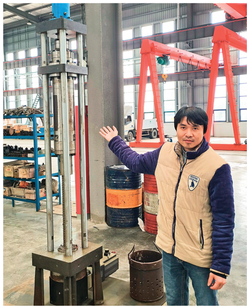
▲真三轴六面顶液压机在高压中子谱仪 BL15 线站安装时的场景。（桂冶公司供图）
