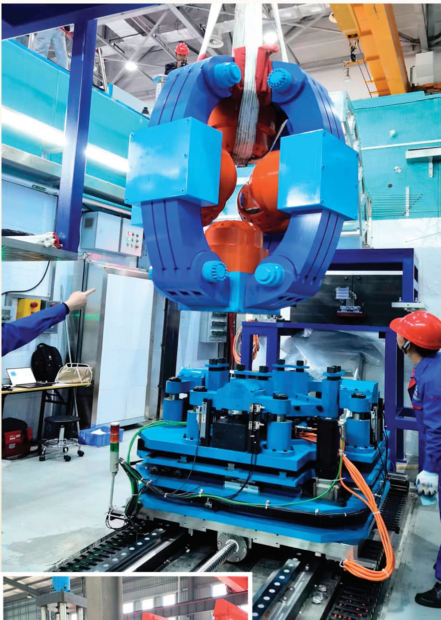
▲真三轴六面顶液压机在高压中子谱仪 BL15 线站安装时的场景。（桂冶公司供图）
