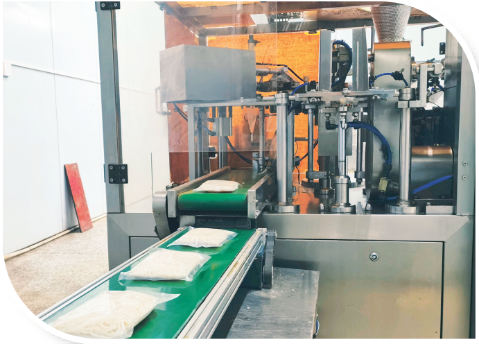
▲在裕兴兴公司米粉“魔方”工厂里，桂林米粉全自动化生产线正在生产预包装桂林米粉。
