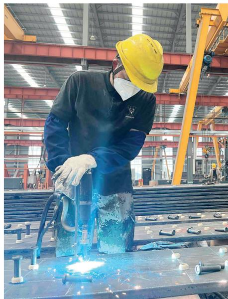
▲永福苏桥镇福龙工业园的广西惠昌创展钢结构有限公司是桂林市第一家全产业链装配式建材生产企业，是钢结构工程设计、制作、安装、研发一体化的钢结构生产基地，年产钢结构10万吨，每年可实现销售收入5亿元，年纳税2500万元，增加就业约300人。高温下，工人全力投入生产。图为工人正在进行栓钉焊接。 记者周文琼 通讯员刘玉婷 摄
