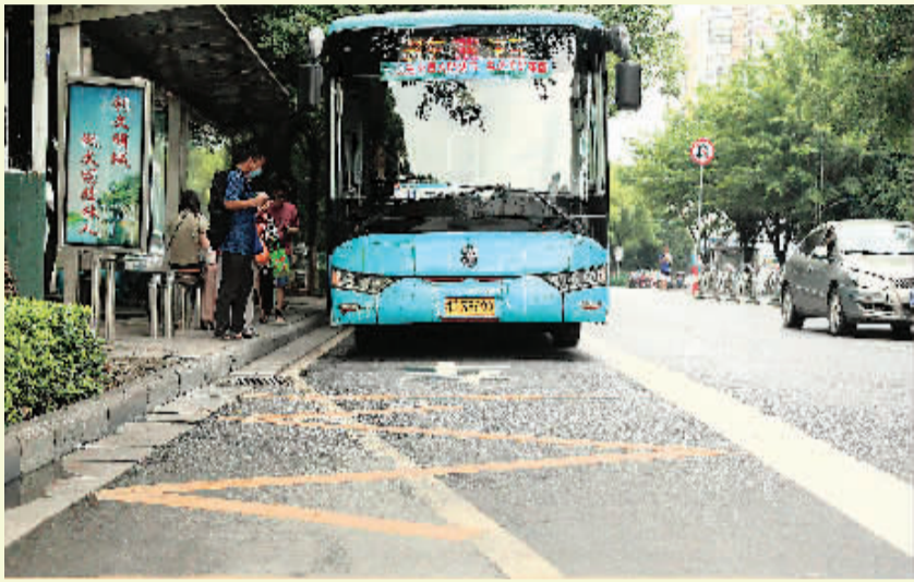
▲市区不少公交站前的路面都重新施划了停靠区域,区域内标注“公交车”三个字,两端还施划了黄色实线和实折线,十分醒目。
