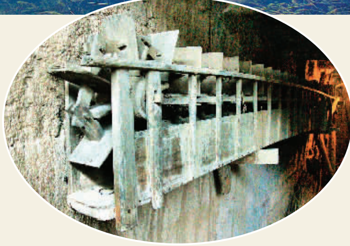
▲古桂柳运河边下庄村木匠制作的龙骨水车，曾是世代沿用过的抽水灌溉工具。 通讯员赵积亮 摄
